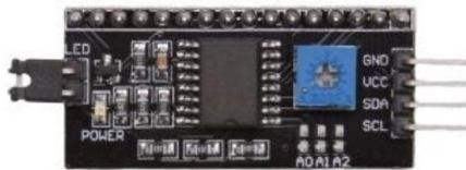
Gambar 2.4 Bentuk Fisik I2C NodeMCU sendiri sudah mendukung protokol I2C/IIC. Dipapan NodeMCU, Port I2C terletak pada pin D1 untuk SDA (Tabel 2.1. Spesifikasi NodeMCU V3) dan D2 untuk SCL (Serial Clock).
