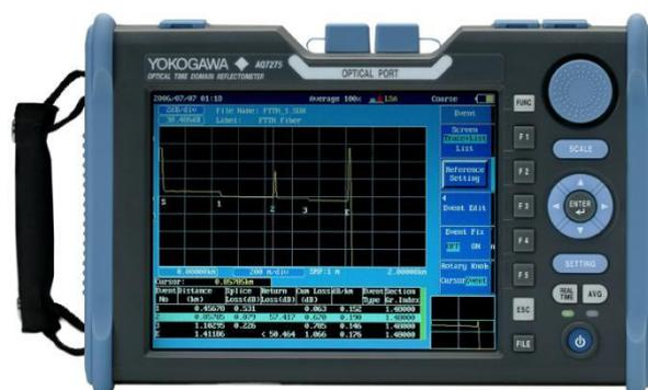
Crack, Putusnya core yang belum diketahui letaknya, Putusnya kabel atau juga untuk melakukan bending.
