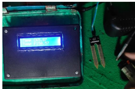
Gambar 4.4 kalibrasi DS18B20 panas
